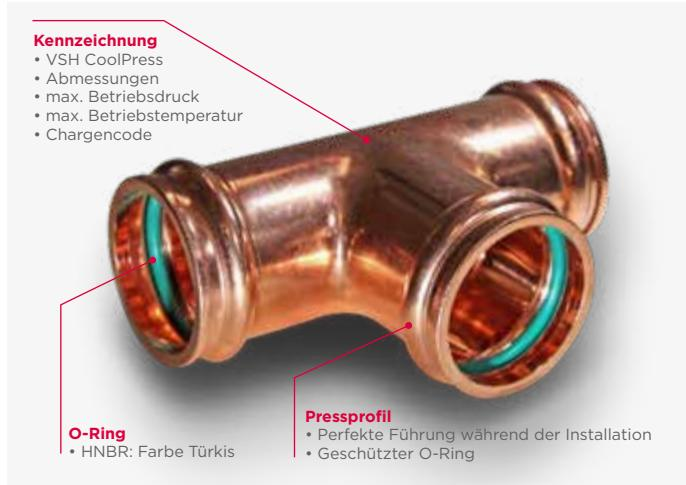
VSH CoolPress Fittings werden aus Cu-DHP (CW024A) hergestellt und sind serienmäßig mit einem türkisfarbenen HNBR-O-Ring ausgerüstet.
